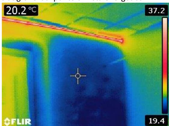
Figura 1.2 – Immagine termografica muro perimetrale
