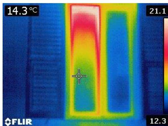
Figura 2.5 – Immagine termografica muro dall'esterno
